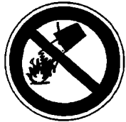
Verboden met water te blussen
