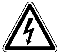
Gevaar voor elektrische spanning
